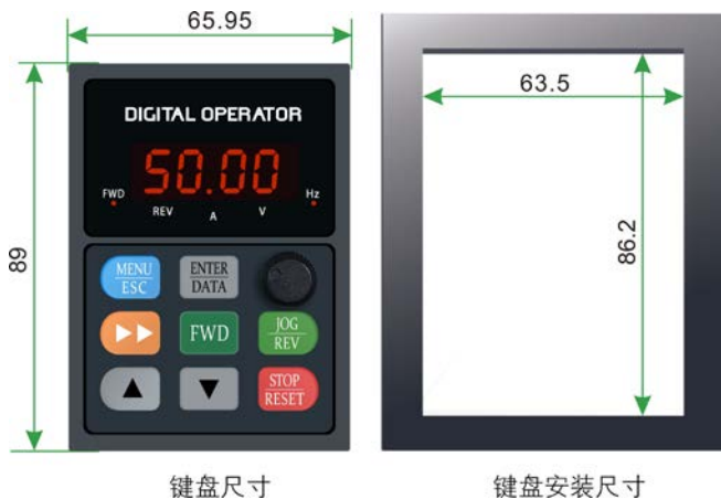
图 2-6 数码显示操作面板尺寸
