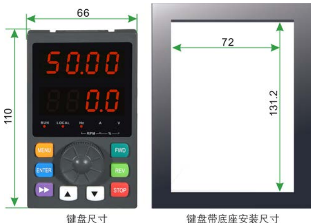
图 2-7 液晶+数码显示操作面板尺寸、安装开孔尺寸
